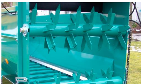
Вал разбрасывающего аппарата с измельчающими ножами (опция)
